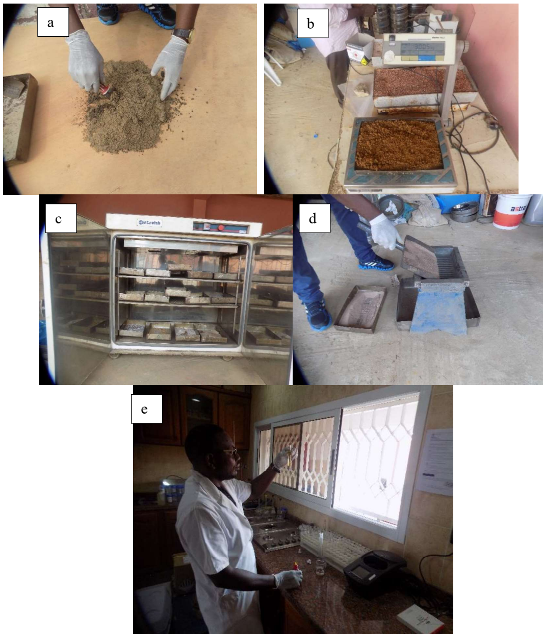
(a) Homogénéisation , (b) pesage, (c) séchage à l'étuve, (d) quartage et homogénéisation (e) analyse chimique,
