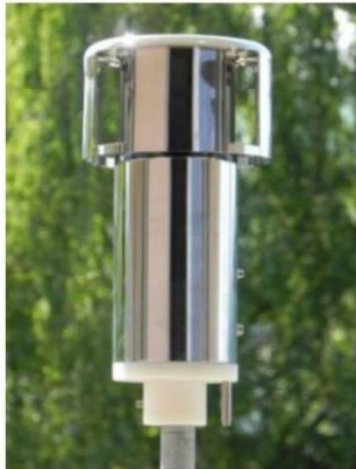
Fig. 2. Système d'échantillonnage des poussières par sédimentation et fixation sur plaque
