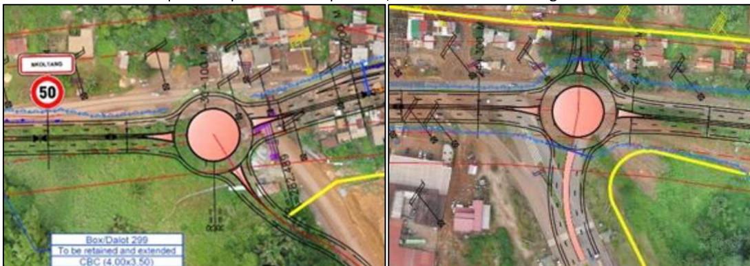
Figure 36 Optimisation de l'implantation des carrefours giratoires
