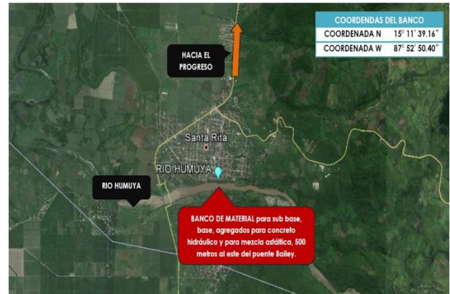
BANCO DE MATERIAL PARA SUB BASE, BASE GRANULAR Densa, AGREGADOS PARA CONCRETO HIDRAULICO Y AGREGADOS PARA MEZCLA ASFALTICA "RIO HUMUYA" 500 METROS AGUAS ARRIBA DE PUENTE BAILEY
