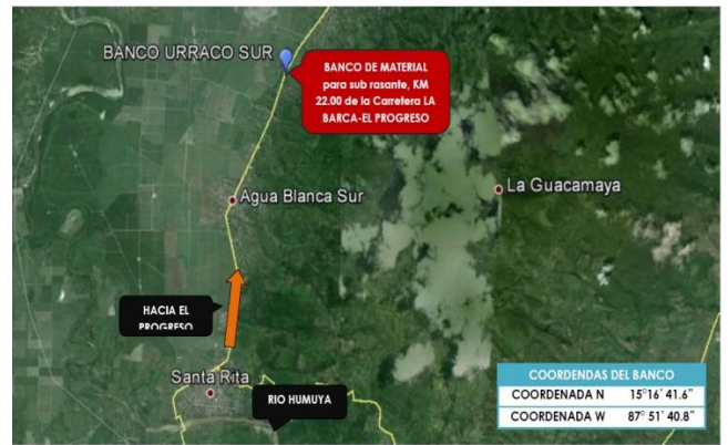
BANCO DE MATERIAL PARA SUB RASANTE "URRACO SUR" KM 22.0 CARRETERA LA BARCA-EL PROGRESO
