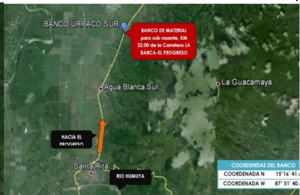
BANCO DE MATERIAL PARA SUB RASANTE "URRACO SUR" KM 22.0 CARRETERA LA BARCA-EL PROGRESO
